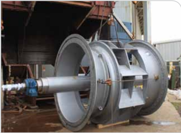
New backward-inclined-style fan blade.
